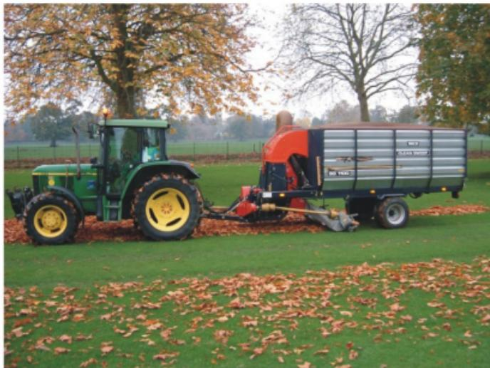
Сборщик Sg1100 оборудован турбиной диаметром 960 мм с двойным кожухом и уникальными подшипниками. Двойной привод с помощью V-образных ремней и технический люк снизу делают обслуживание сборщика простым, а его работу плавной и тихой.
