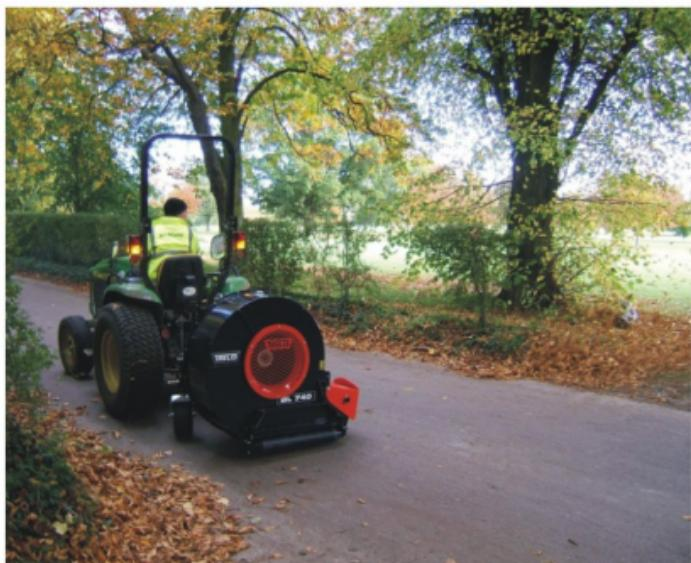
Мощная прицепная воздуходувка BI740 подходит для категорий сцепки 1 и 2. Таюке воздуходувка оборудована специальным роликом, который предотвращает повреждения почвы и травы.
