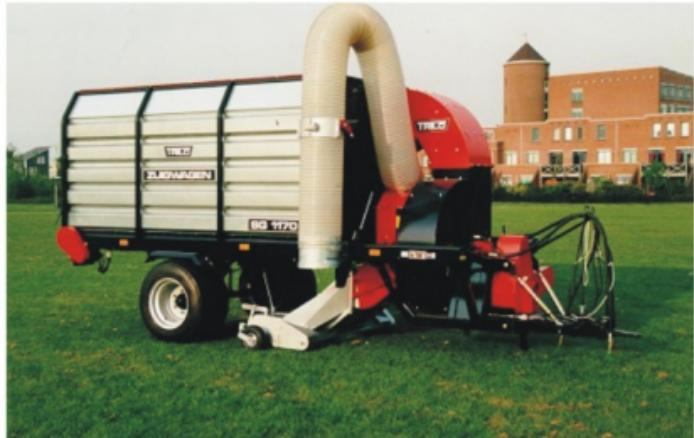
Сборщик Sg1170 совмещает две лучшие модели Trilo. Он оборудован самой мощной турбиной и облегченной рамой от модели Sg700. Таким образом Sg1170 обладает максимально возможной мощностью при минимальном давлении на почву.
