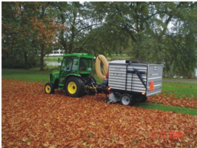
Небольшой вакуумный сборщик для малых тракторов на котором можно регулировать длину и высоту сцепки. Отличная производительность мощности сборщика и маневренность компактного бункера позволяет использовать машину в труднодоступных местах.
