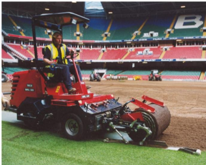
Самоходный укладчик рулонного газона BRL120 способен быстро и качественно работать с рулонами шириной 120см. Укладка рулонов происходит быстро и плотно так как машина оборудована семью колесами с полным гидравлическим приводом.
