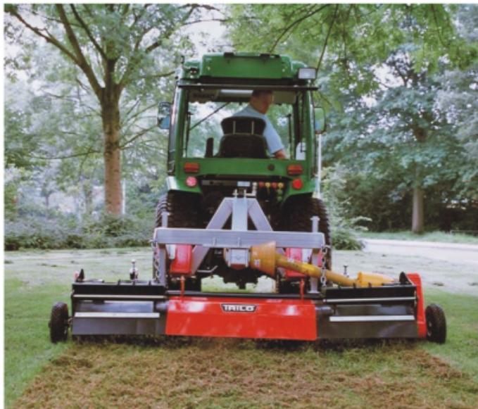
Вычесыватель VCMK обладает трехсекционной плавающей конструкцией, которая точно копирует рельеф почвы и способна работать даже на самом сложном грине. Вычесыватель также устанавливается на вакуумный сборщик, превращая его в многофункциональную машину. Кроме того VCMK можно использовать как прорезной аэратор с любой техникой мощностью более 25 л.с.
