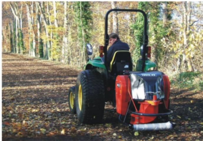
Воздуходувка BL400 была специально разработана для уборки больших территорий. BL400 можно установить как спереди, так и сзади трактора мощностью 25 л.с., А вращающийся патрубок позволяет сдувать материал как справа так и слева.
