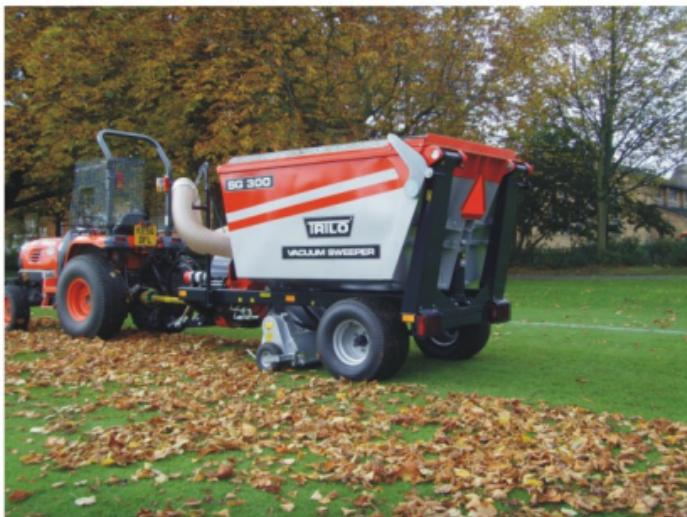
Небольшой вакуумный сборщик для очистки полей и улиц с шириной захвата 1,4 м. Компактный бункер и высокая мощность всасывания позволяют работать даже во влажных условиях.
