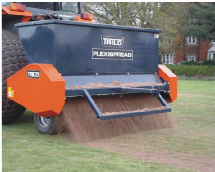
Пескователь Fs1500 подходит для работ с сухим песком, влажной присыпкой, гравием, резиновой крошкой, ракушками. Машина оборудована плавающими роликами и вместительным бункером, что позволяет равномерно вносить максимальное количество материала.
