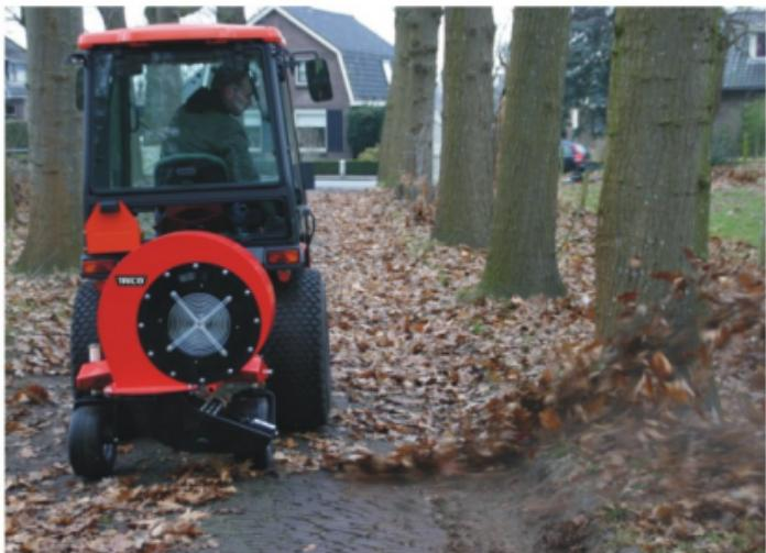
Легкая и маневренная воздуходувка BL300 отлично подходит для уборки гольф-полей, спортплощадок и футбольных полей с натуральным и искусственным газоном. Воздуходувка оснащена вращающимся соплом с гидравлическим приводом. Лопасти турбины динамично сбалансированы, а плавный ременной привод обеспечит долгий срок службы.
