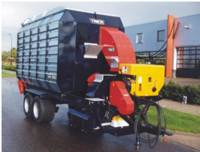
С помощью сборщика Sg1500 можно собрать любой мусор, листья или траву. Машина может быть оборудована дополнительной осью с колесами, что позволит передвигаться со скоростью до 80 км/ч, а в комплекте с насадкой Unimog любой трактор превратится в многофункциональную машину с поразительной скоростью работы.
