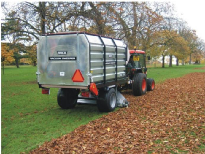
Сборщик Sg670 оборудован ручным или механическим шлангом с пылесосом, который способен засосать мельчайшие частицы с помощью высокомощной турбины TriLo.
