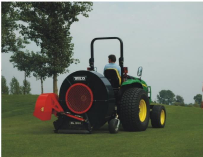
Самая мощная воздуходувка BI740 была специально сконструирована, чтобы стать самой мощной на рынке. Машина максимально подходит для работ в больших парках или на гольф-полях. Воздуходувку можно оборудовать обратным патрубком для работы в двух направлениях.
