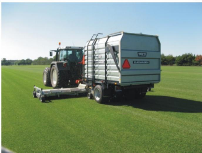
Вместительный сборщик Sg1165 с бункером на 11 куб. Метров, турбина диаметром 960 мм с двойным кожухом и уникальными подшипниками. Двойной привод с помощью V-образных ремней и технический люк снизу делают обслуживание сборщика простым, а его работу плавной и тихой.
